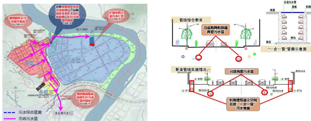
污水管网体系及“一企一管”分析图
